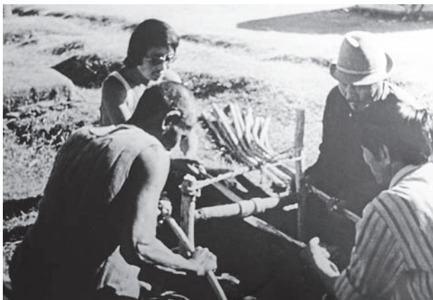
Рис. 2. Полевой сверлильный станок кочевников
