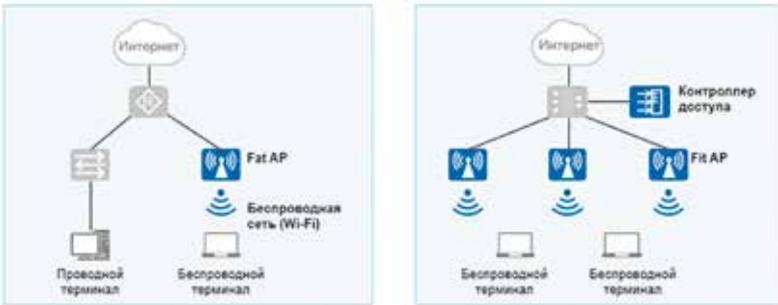
**Рис. 7.** Беспроводные устройства
