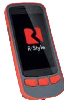
любые погодные условия в диапазоне температур от -20 до +55°C и сопротивляется 15-кВ воздушному электрическому разряду. Кроме того, благодаря резистивной технологии экрана им можно пользоваться в перчатках. Полный рабочий день при непрерывной нагрузке обеспечивает съемный аккумулятор емкостью 5000 мА·ч, а резервная встроенная батарея емкостью 800 мА·ч подстрахует в непредвиденных обстоятельствах.
