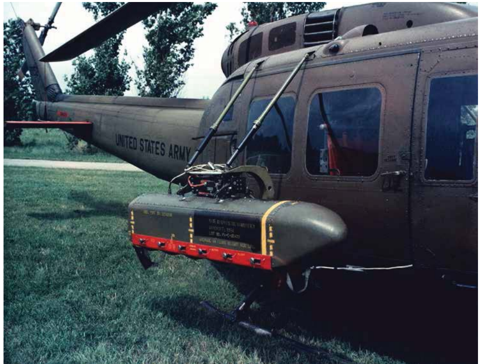
► Многоразовый контейнер SUU-13A с 80 противопехотными минами системы дистанционного минирования M56 на пилоне вертолета УН-1 «Ирокез». За один вылет вертолет, оснащенный двумя такими контейнерами, мог выставить минное поле размерами 100x40 метров (Фото Национального управления архивов и документации США)
