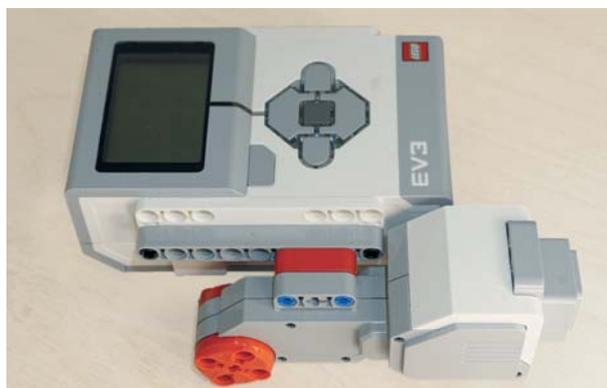
5. Теперь необходимо собрать второй привод. Для этого возьми ещё один большой мотор и поверни его разъёмом вправо. В крепление возле привода вставь короткими концами два синих 3-модульных штифта в первый и третий модули.
