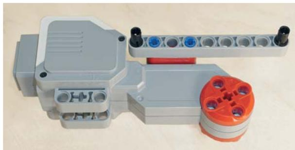
4. Возьми программируемый модуль EV3 и поверни его так, чтобы порты, обозначенные буквами, находились слева. Установи собранную деталь свободными концами чёрных штифтов в серой балке № 9 — вставь их во вторые модули вертикальных креплений так, чтобы разъём на большом моторе находился справа.
