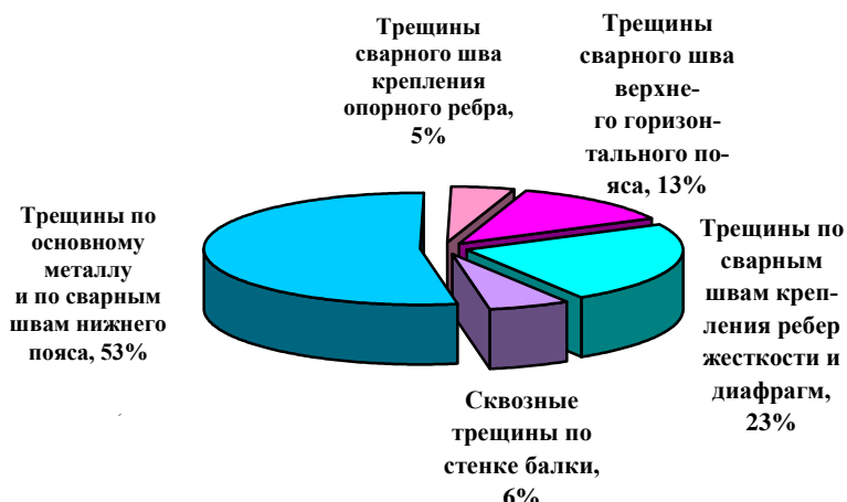
Рис. 1.14. Диаграмма зонального распределения трещин в металле и сварных швах подкрановых балок (ОПЛС ККЦ ОАО «ММК»)
