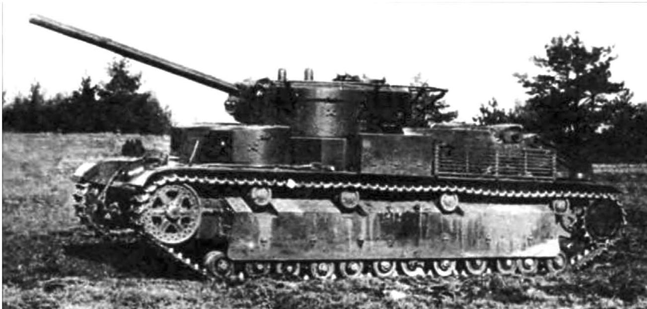
**Танк Т-28 с установленной в нем опытной 95-мм пушкой Ф-39. Это орудие, разработанное под руководством В. Грабина, не получило дальнейшего развития из-за перехода на больший калибр – 107-мм (ГАНО).**
